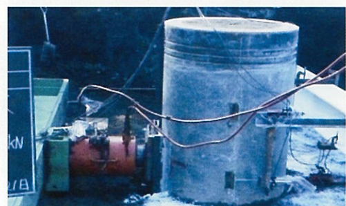
杭の水平荷重試験
