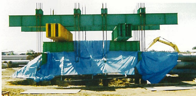
杭の押し込み荷重試験
