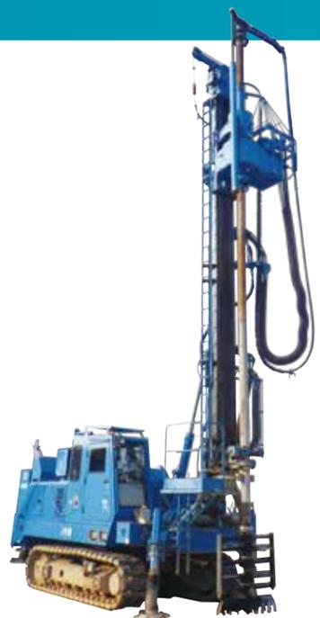
MSコラム・E工法は、セメント系固化材のスラリーを吐出しながら地盤を掘削攪拌することで、柱状の地盤改良体を築造する機械攪拌式深層混合処理工法です。400~2,000kN/m<sup>2</sup>の設計基準強度を確保でき、改良体コアの一軸圧縮強さの変動係数として、砂質土および粘性土で25%が採用できます。
